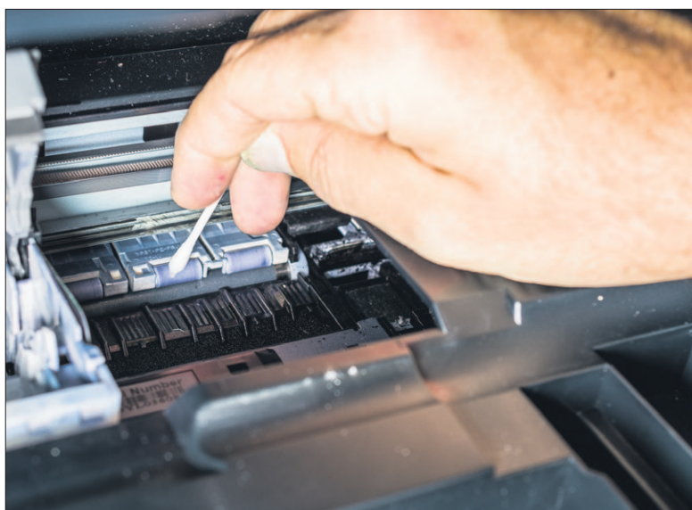
11 Reinigen Sie die Einzugsrollen mithilfe eines befeuchteten Wattestäbchens. Die Rollen befinden sich unterhalb und hinter dem Schlitten. Sie verlaufen über die ganze Breite des Druckers.
