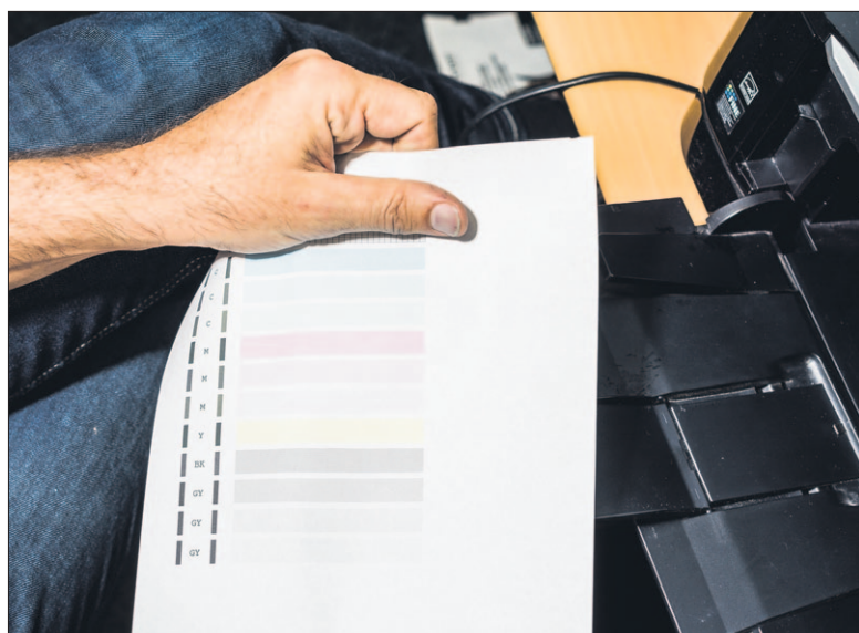
12 Setzen Sie anschliessend den Druckkopf und die Patronen ein. Schliessen Sie die Druckerabdeckung. Nach der Initialisierung starten Sie einen Testausdruck.
